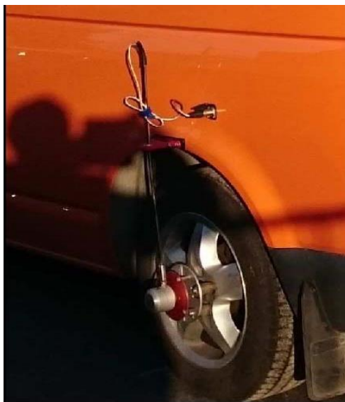
Rys. 4.1. Czujnik pomiaru odległości zamontowany na kole
