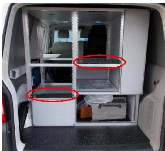
Rys. 3.2. Listwy zasilające z gniazdami 230 V.
