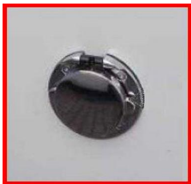
Rys. 3.3. Dodatkowe wyposażenie elektryczne: a) zewnętrzne gniazdo ładowania 230 V, b) widok gniazda, c) przewód podłączeniowy
