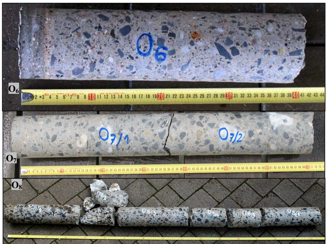
Rys. 8.3 Widok odwiertów O 6 (przyczółek P7), O 7 (filar P6) oraz O 8 (filar P4)
