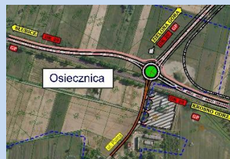
(4)- Skrzyżowanie proj. obwodnicy w m. Osiecznica z istn. DK29 i z ul. Polną w Wariantie II i III (początek opracowania)
