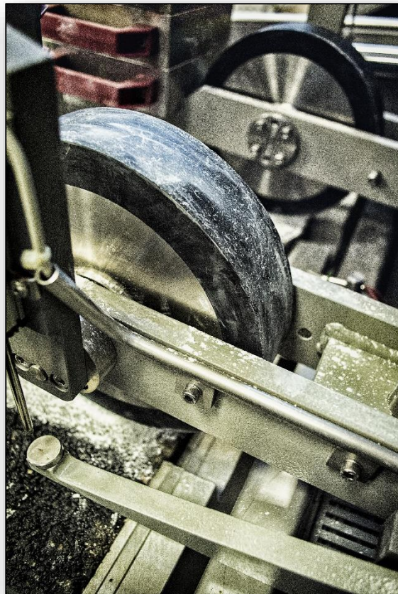
Koleinierz mały – badanie odporności na koleinowanie
