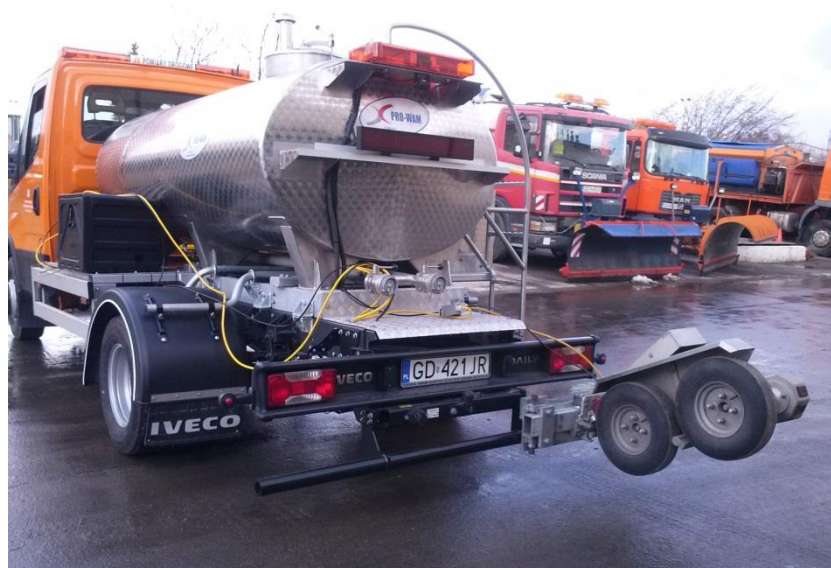
Rys. 7.2. Samochód pomiarowy z zamontowanymi elementami składowymi systemu TWO
