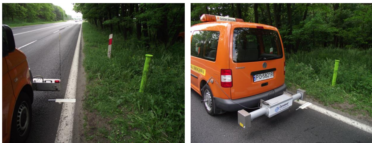
Rys. 3.1. Oznaczenie początku i końca odcinka kalibracyjnego dystansomierzy
