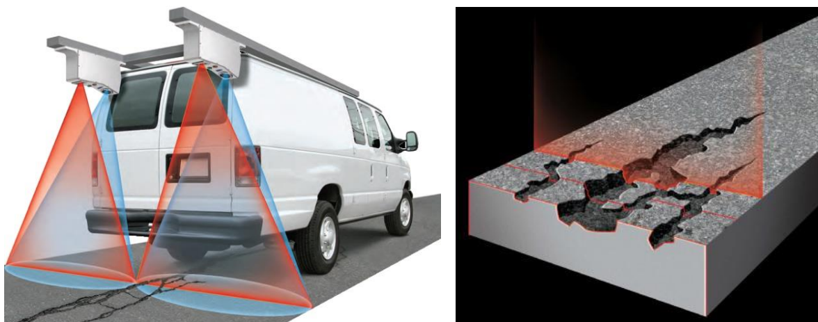
Rys. 8.1. Zestaw do pomiaru spękań nawierzchni oraz widok ogólnej zasady działania systemu
