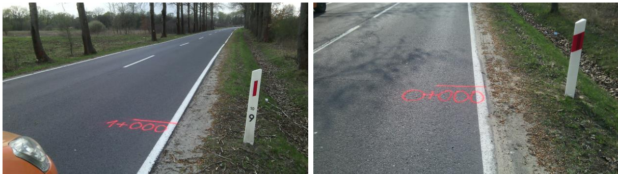
Rys. 3.1. Oznaczenie początku i końca odcinka kalibracyjnego dystansomierzy
