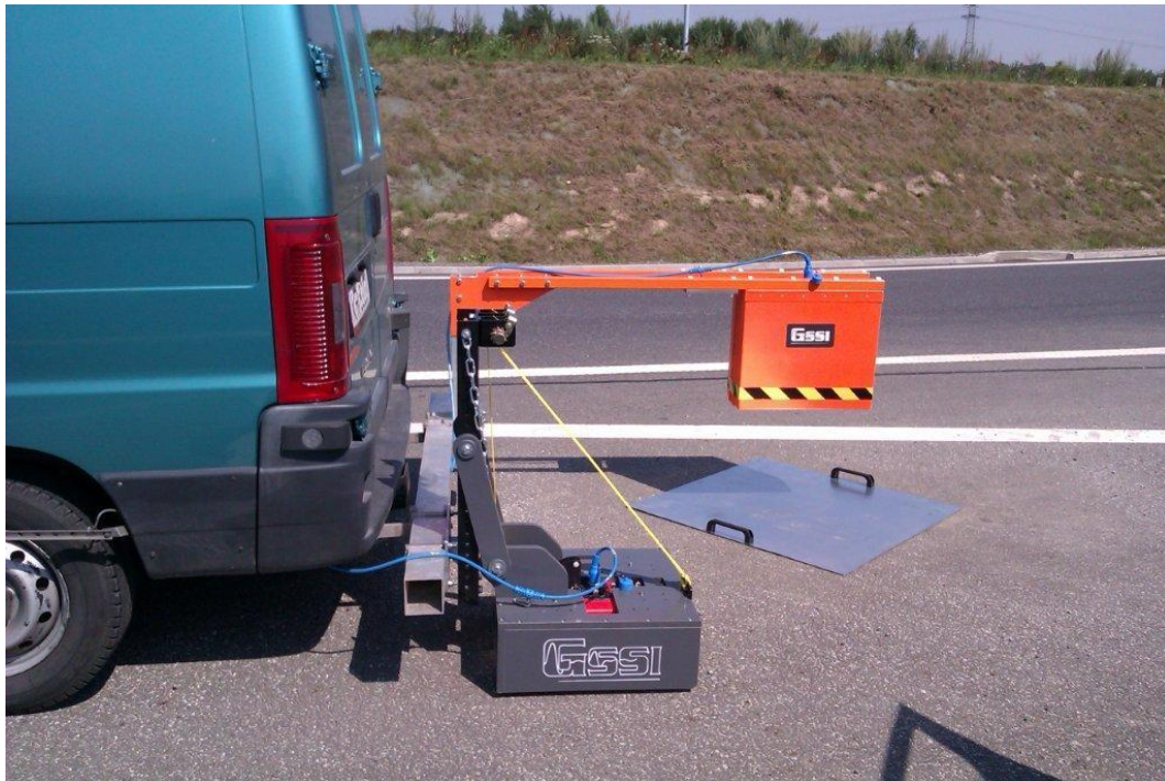
Rys. 10.1. Samochód pomiarowy z zainstalowanymi antenami 1 GHz i 0,4 GHz.
