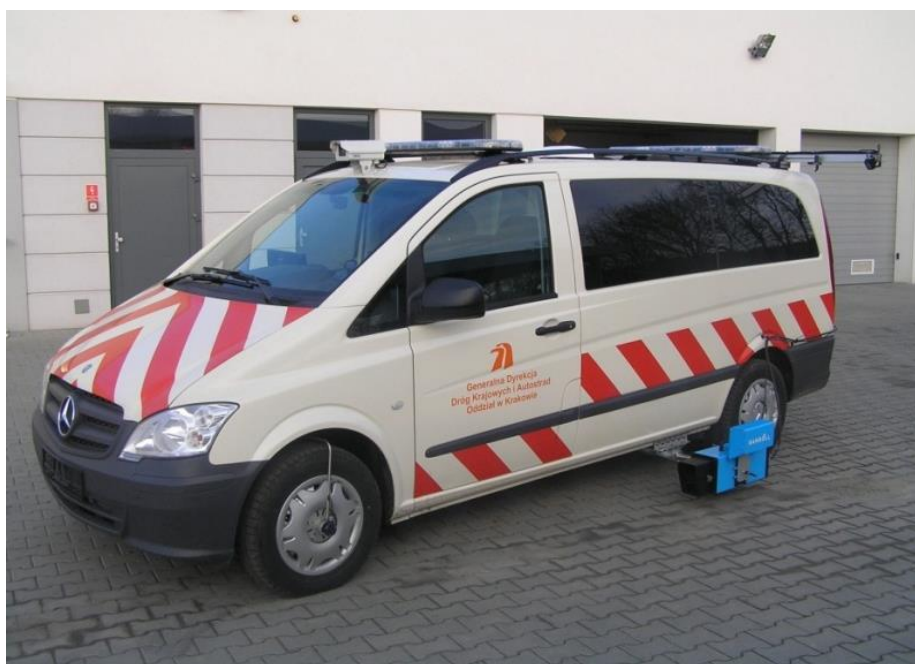
Rys. 9.2. Samochód pomiarowy z zamontowanymi elementami składowymi systemu typu RMT 2.0.
