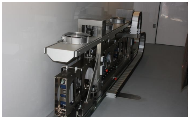
Rys. 2.2. Belka z czujnikami pomiarowymi
