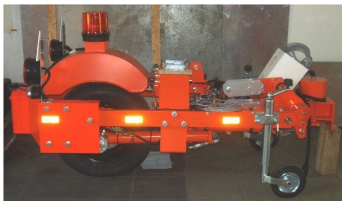
Rys. 6.1. Zestaw pomiarowy i przyczepa pomiarowa SRT-3
