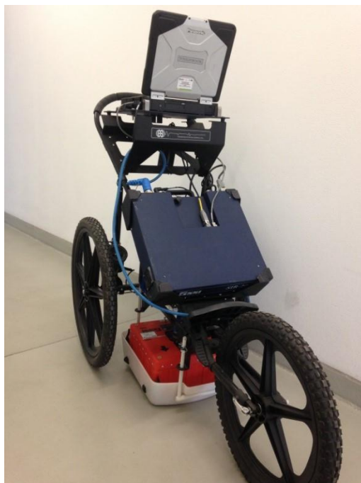
Rys. 10.2. Wózek pomiarowy z anteną 0,4 GHz
