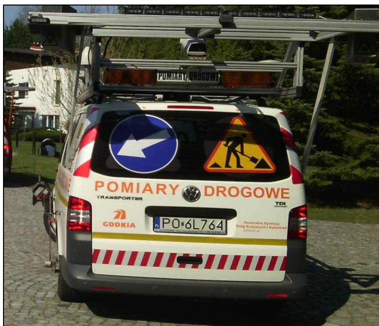
Rys. 1.1. Zestaw LCMS — widok na instalację zestawu kamer pomiarowych
