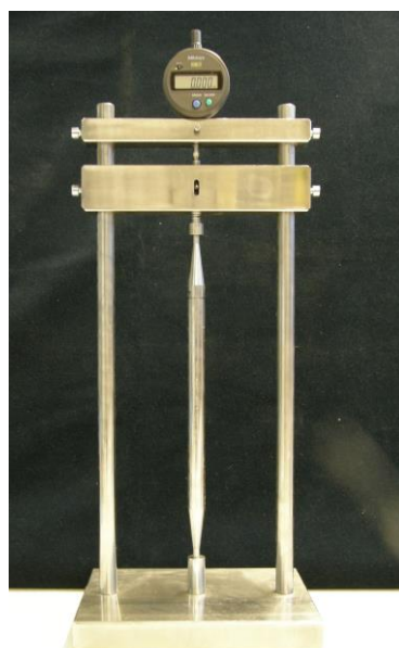
Rysunek 1. Urządzenie pomiarowe (dylatometr) o konstrukcji ulepszonej, z invaru
